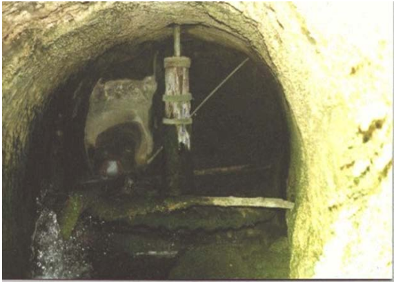
Rodezno en funcionamiento (Foto JMR)
