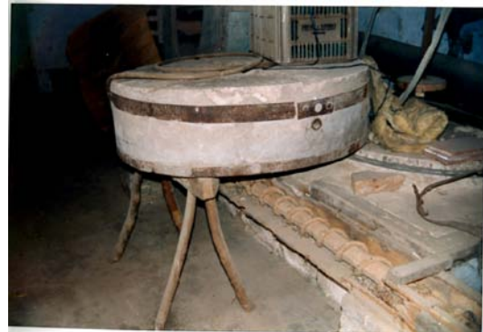
Empiedro dispuesto a ser picado Tornillo sinfín rudimentario (Foto JMR)
