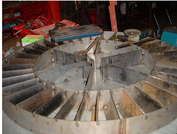
Fabricación de un rodezno (G.Moris)
