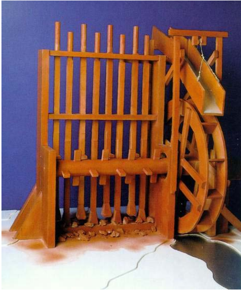
Fig. 3. Maqueta de un molino de almadenetas. Exposición Felipe II. Los ingenios y las máquinas
