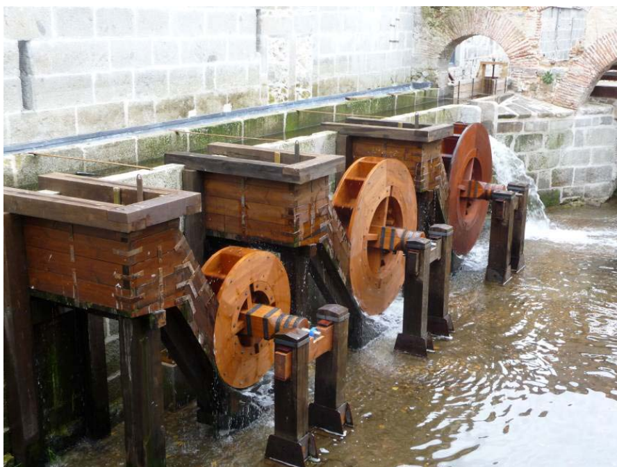
Fig. 5. Las tres ruedas de la Casa de la Moneda de Segovia, colocadas y funcionando
