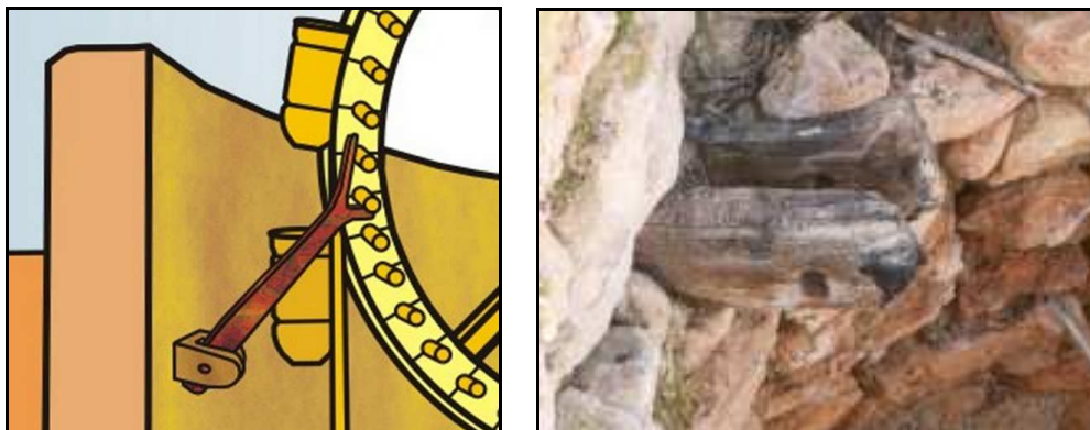
Figura 4: Esquema del mozo o gato de la aceña de madera del Campo de Cartagena
