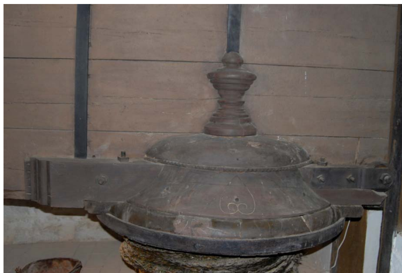
Figura 2. Vista del marrano con el que se procedía al apriete del cargo de capachos
